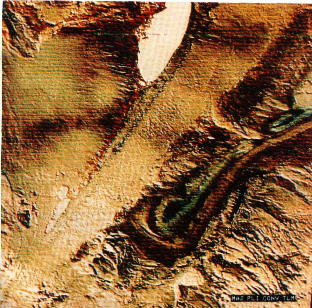
图3 分段线性增强、卷积变换、跟踪球变换处理的 玛纳斯湖卫星影像
